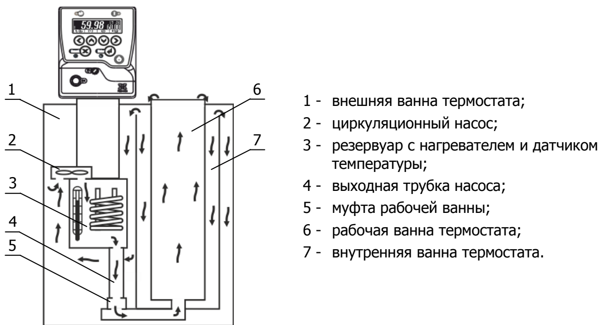
Рисунок 3 — Устройство термостата
